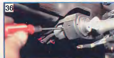
Отворачиваем два винта крепления корпуса замка к кронштейну.
