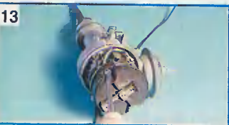
Отворачиваем два винта бегунка и снимаем его.
