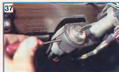
Поворачиваем ключ зажигания на 1/4 оборота и через отверстие в кронштейне утапливаем язычок фиксатора.
