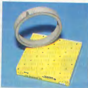
Из такой чугунной отливки получают три кольца.
