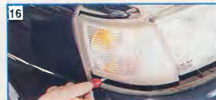
Ключом "на 10" отпускаем гайку наружного крепления блок-фары и...
