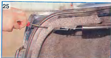
Крестообразной отверткой отворачиваем четыре самореза крепления обивки багажника.
