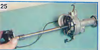
...и вынимаем валик вместе с центробежным регулятором.
