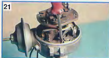
...перемещая подвижный контакт, устанавливаем зазор 0,35–0,45 мм...
