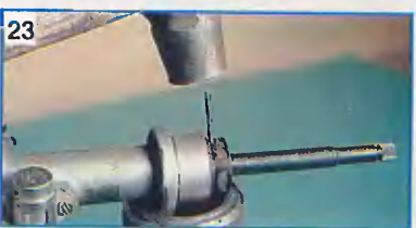
Подходящей выколоткой выбиваем штифт.
