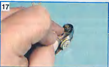
Выводим пружину подвижного контакта из упора.
