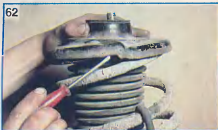
Верхний конец пружины совмещаем с выступом верхней чашки...
