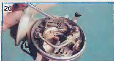
Снимаем стопор оси тяги вакуумного регулятора.
