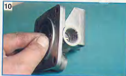
10 Подходящей проволокой очищаем жиклер выравнивания давления.
