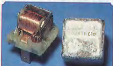
Реле 112.3747 с эмблемой АО "АВАР" и знаком качества — как-никак, "Сделано в СССР". После испытаний изделие приобрело жутковатый вид, однако работоспособность сохранило. Кстати, герметичность древнего корпуса оказалась на высоте — до внутренних поверхностей коррозии не добралась.
