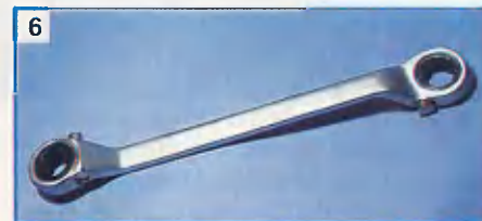
6 Накладной ключ с трещотками в головках очень удобен для ремонта рулевой трапеции.
