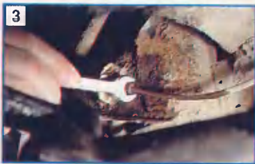
Смачив штуцеры тормозных трубок проникающей смазкой, ключом "на 10" отворачиваем их. Чтобы не вытекала жидкость, на трубки можно надеть резиновые защитные колпачки.
