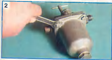
2 Ключом "на 12" отворачиваем четыре винта крепления резервуара к корпусу.
