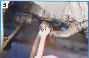
Ключом "на 19" отворачиваем гайку этого пальца...
