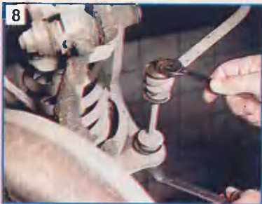
Двумя ключами "на 17" отворачиваем гайки стоек и снимаем с них стабилизатор.
