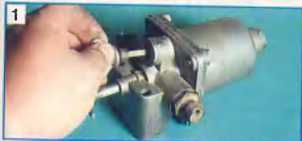
1 Вывернув мерный щуп, проверяем состояние уплотнительного кольца.
