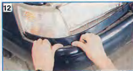
Поджимаем угол накладки к фаре и немного вверх, чтобы нижняя часть накладки вышла из зацепления с бампером и...
