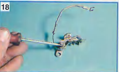
Снимаем с оси стопор и подвижный контакт.
