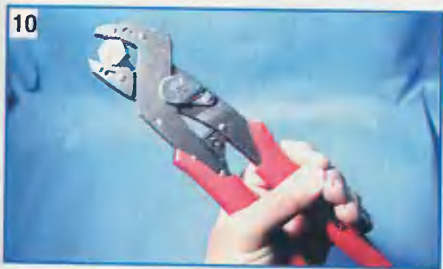
Альтернатива газовому ключу № 1 – пассатижи Signet. Достоинства их – мощные, параллельно движущиеся губки и автоматический захват.
