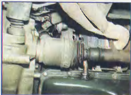
Турбокомпрессор притаился за приводом правого колеса. К нему присоединена приемная труба глушителя и магистраль слива масла в картер двигателя.
