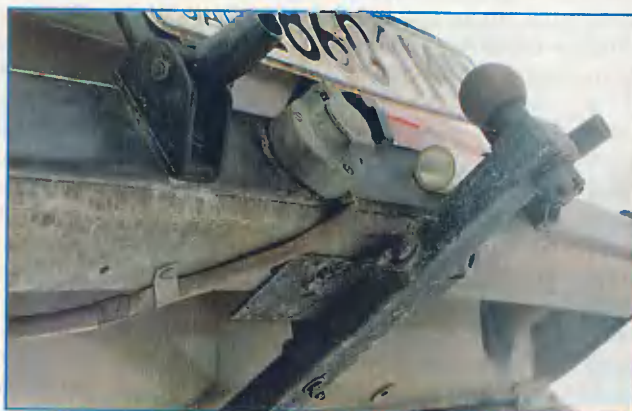
Петли изготовлены из двух наложенных друг на друга уголков. Концы труб кронштейна ограничивают угол откидывания колеса.
