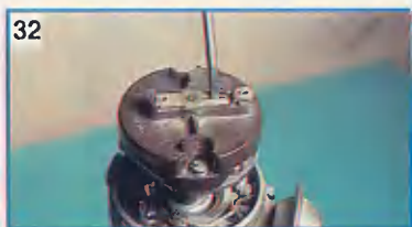
Помехоподавительный резистор номиналом 5,6 кОм временно можно заменить "жучком" из проволоки.
