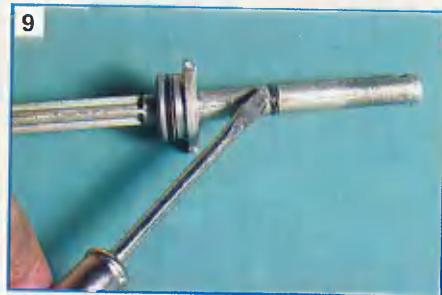
9 Уплотнительное кольцо штока предотвращает утечку воздуха в атмосферу.
