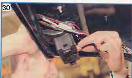
Снимаем колодку питания фонаря.
