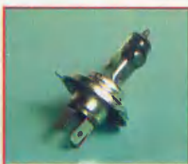
Вздумавшая лампа хоть и светит, но провисшая нить ухудшает границу ближнего света.
