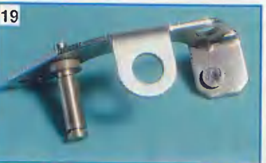
На этом контакте хорошо видна глубокая лунка – следы электроэрозии.
