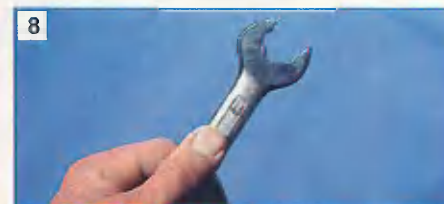
8 Ключи с захватом за грани – для прижавшихся гаек.
