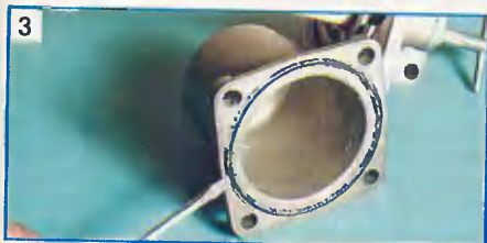
3 Проверяем состояние уплотнительного кольца.
