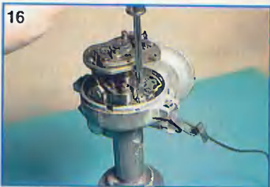
Выворачиваем два винта крепления контактной группы.
