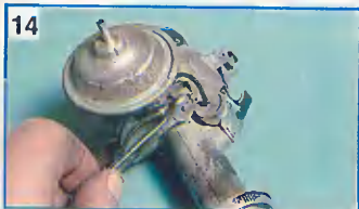
Ключом "на 7" ослабляем гайку зажима прерывателя...
