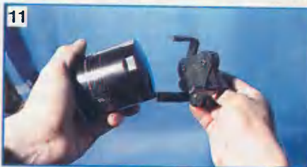
Для замены масляных фильтров на хитроумных иномарках, бывает, не хватит суставов на руке – так трудно к ним подобраться. Выручает специальный съемник. Будь его захваты потуже, работать стало бы еще удобнее.
