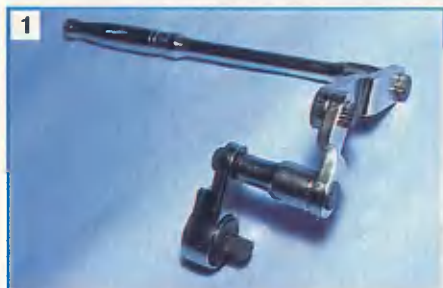
1 С таким набором удлинителей можно крутить гайки хоть из-за угла.
