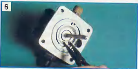
6 Снимаем стопорное кольцо...
