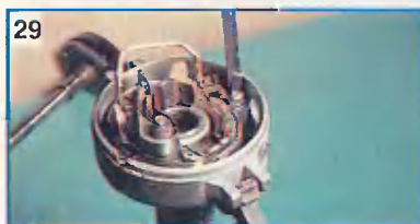
Отворачиваем два винта неподвижной пластины и отсоединяем провод прерывателя.
