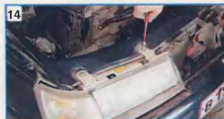
Ключом "на 10" отворачиваем два верхних болта крепления блок-фары и...
