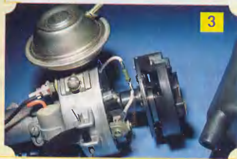
Рис. 3. Так можно доработать классическую систему зажигания. R — дополнительный резистор, подключаемый к подвижному контакту прерывателя.
