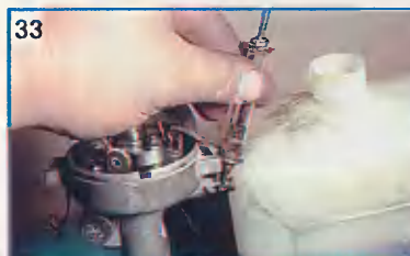
При сезонном обслуживании заливаем в масленку несколько капель моторного масла.
