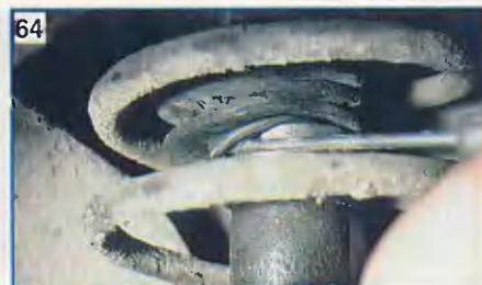
Собрав стойку, заправляем нижний край защитного чехла за накидную гайку.
