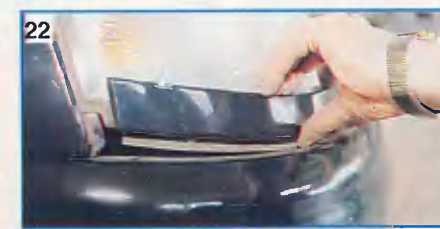
Поджимаем переднюю часть накладки к фаре и немного вниз, чтобы нижняя часть накладки зашла за бампер.
