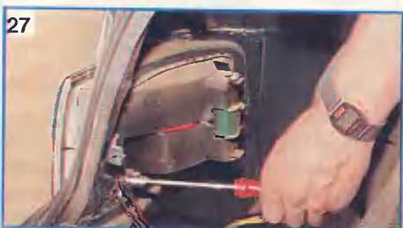
Ключом "на 8" отворачиваем три гайки крепления корпуса фонаря и...
