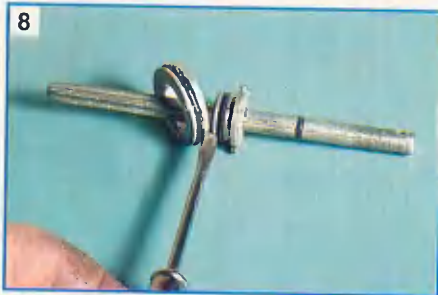
8 Проверяем состояние уплотнительных колец, разобщающих испарительную камеру и резервуар.
