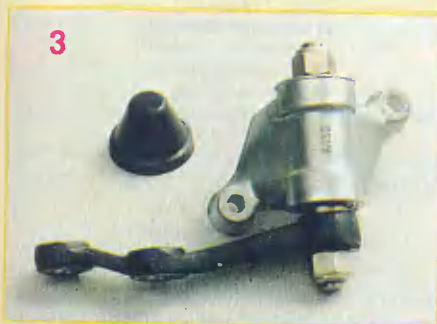
Маятниковый рычаг на подшипниках, сделанный по "классической" схеме.
